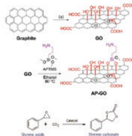
▲図1 アミノプロピル基で修飾されたGOの調製過程と、スチレンカーボネイト生成の反応。
