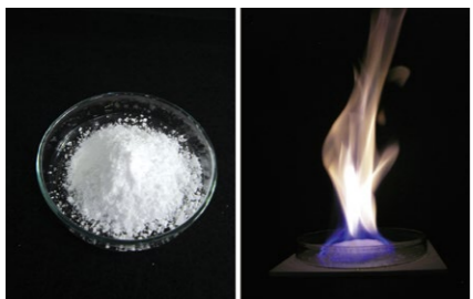
図1:人工的に生成したメタンハイドレートとその燃焼の様子(産業技術総合研究所提供)
