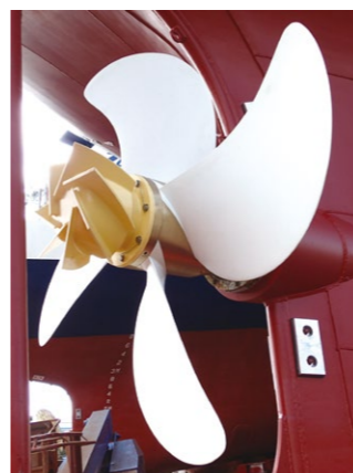
図1. 世界初の一般商用CFRPプロペラ (ナカシマプロペラ)
