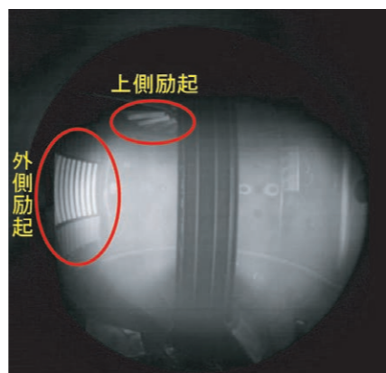
図2. TST-2球状トカマク装置において、高周波波動のみにより生成され、電流駆動されたプラズマ。
