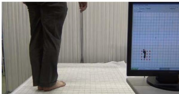
図1. メートル級大面積タッチパネル
