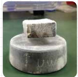
高温超伝導体(下、円柱状)のピン止め効果により浮上する永久磁石(上、直方体)
