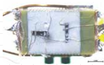
ピエゾ素子を用いた「電子ネマティック」状態を調べる実験配置例
