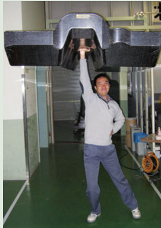
10分で成形したCFRP製自動車フロア (先輩は無理をしていません!)
