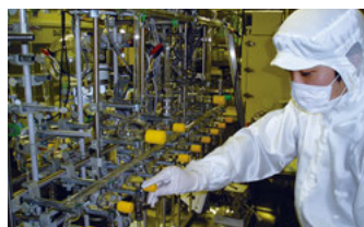
図2：大気粉塵の ^{14}\text{C} 分析のための前処理風景
