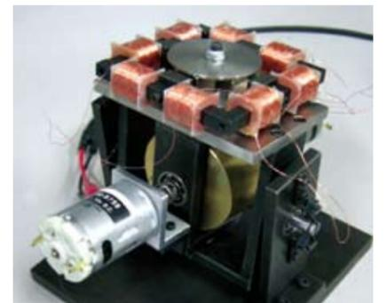
図3: 整流型発電機。ランダム振動でも発電。
