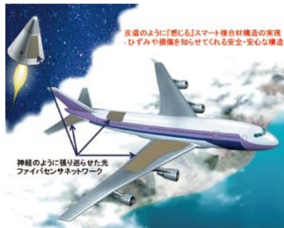
図2：皮膚感覚をもつ次世代スマート航空機複合材構造システム
