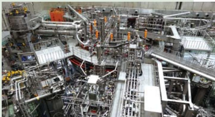
大型ヘリカル装置 日本の土岐市で稼働している大型ヘリカル装置(LHD)。主半径3.6m、小半径0.65mの核融合プラズマを生成し、約1時間の放電を達成している、世界有数の定常プラズマ実験装置です。
