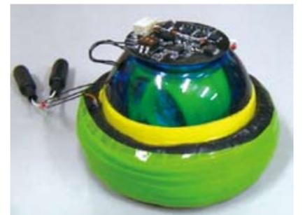
図2: 試作機。2Hzの振動で1Wを出力し、自己起動も行う。
