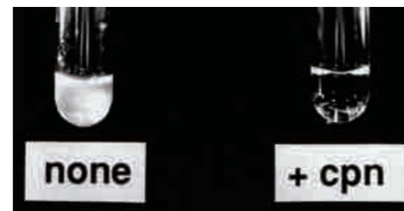
図2: シャペロン(右のcpn: 好熱菌のシャペロニン)を加えた卵白は70°Cで保温しても凝集にならないため透明なまま。
