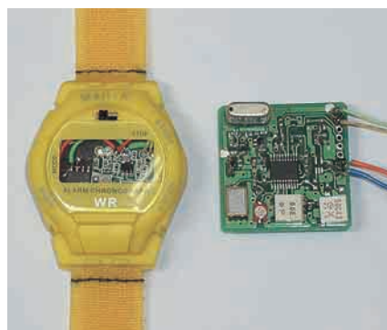
腕時計のケースに組み込んだ送信機(左)と受信機(右)。この距離でも人体を介さないと信号が伝わらない。
