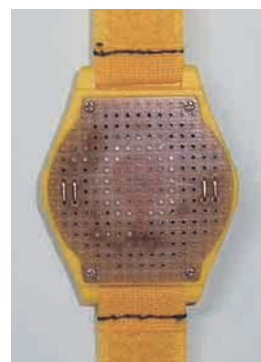
送信機の裏面。左右の端に縦に2本ずつ見える端子が通信用電極。
