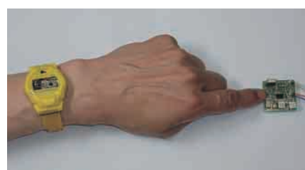
指先で受信機の端子に触れると情報が伝わる。送信機を手首に装着していれば反対の手の指先で触れても通信できる。
