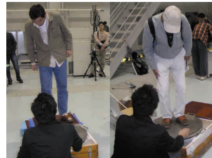
超伝導による浮上実験
