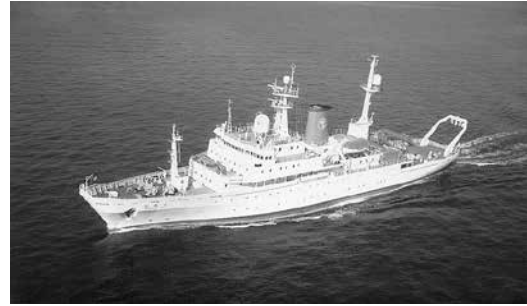
学術研究船、白鳳丸。総トン数 3991t。10 の研究室を持ち、乗船可能研究者数 35 名。1989 年に竣工し、これまでの調査は、太平洋、大西洋、インド洋、南極海など世界全海域に及ぶ。
