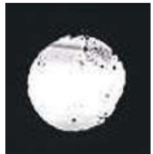
図1: \text{Ni}_2\text{InSbO}_6 結晶のキラルドメイン分布の偏光顕微鏡イメージング像
