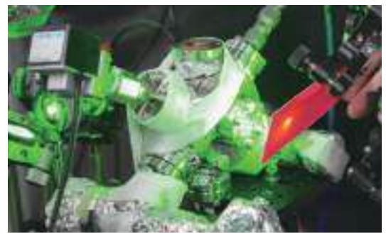
図1:超高速エピタキシャル成膜プラズマビーム
