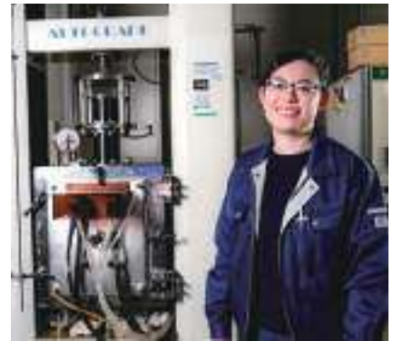
超高温試験機を用いて1000-2000℃の温度範囲で力学特性を評価しています。
