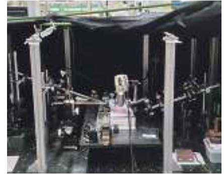
図2: 第二高調波発生による気水界面における分子挙動のその場観察装置
