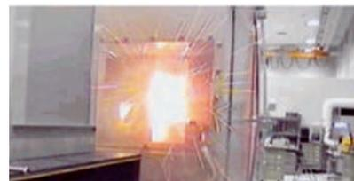
一卷きコイル法による超強磁場発生の瞬間 (VTR映像の二コマ)
