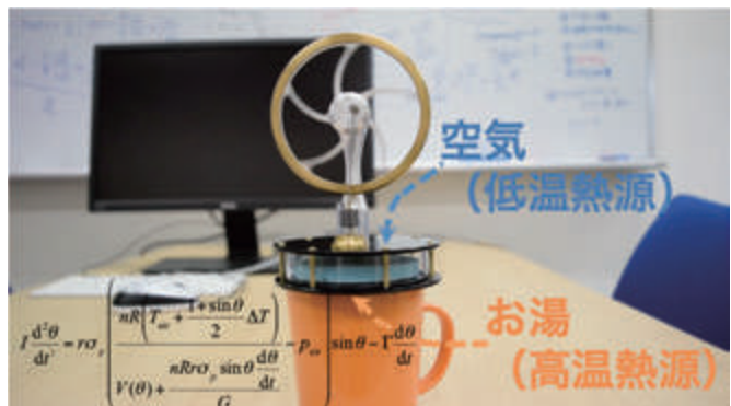
実際の低温度差スターリングエンジン(Kontax)と力学系モデリングによる運動方程式
