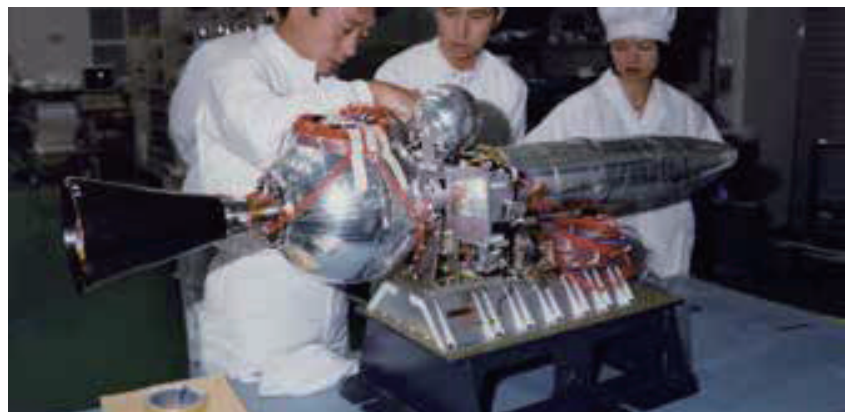
月内部構造探査のために開発を行ったペネトレータ
