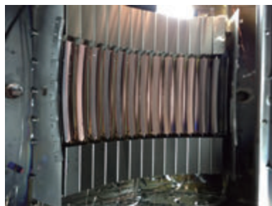
高周波アンテナ
