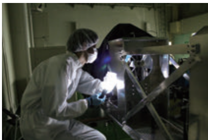
惑星分光観測衛星(ひさき)に搭載された極端紫外分光器の性能評価試験
