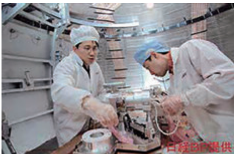
磁気シールドルームにて望遠鏡の組み上げ作業中(かぐや衛星)
