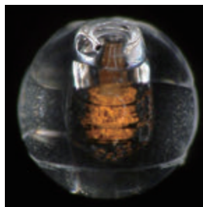
トレーサー内蔵ペレット(Tracer-Encapsulated Solid Pellet: TESPEL)。中心に金粒子が封入されている。
