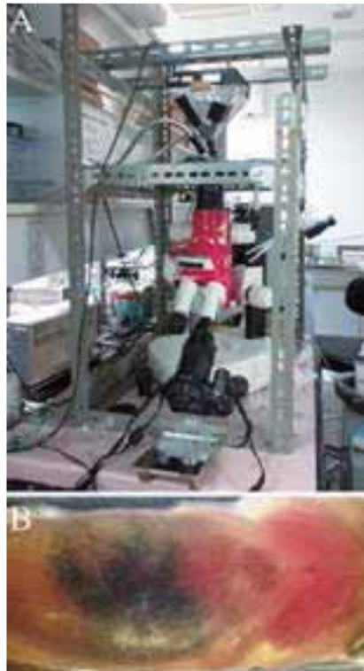
図1: 自作した倒立実体顕微鏡(A)と透明メダカ(SK2)のお腹の拡大写真(B)
