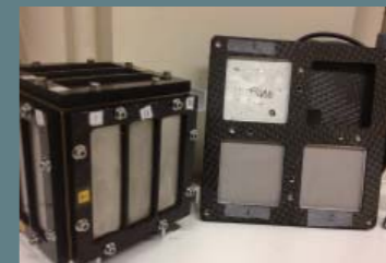
左: 彗星探査機RosettaのPhilaeに搭載されているDIMのスベア機 右: 水星探査機BepiColombo missionの探査機に搭載されるMDMの実験用検出器
