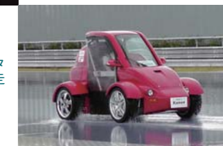
4輪インホイールモータ電気自動車の低μ路走行試験(堀・藤本研)
