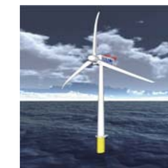
浮体式洋上風力発電システムの模式図 提供：海上技術安全研究所
