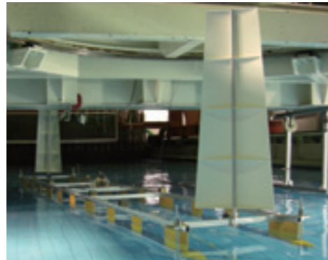
図2: セイリング式洋上風力発電プラントの水槽試験(風車を搭載していない状態)
