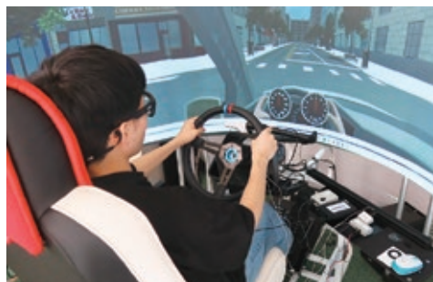
センサーをドライバーの体に取り付け、ドライビングシミュレーターでストレス状態を計測
