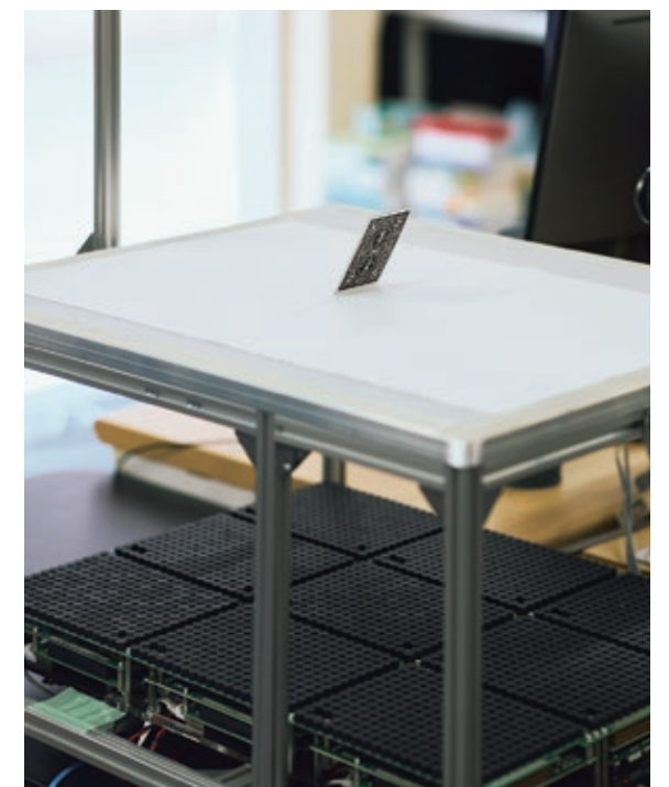
▲ドーナツ状の音響場を利用した軽量物体の浮揚。音響場の形状を変えることで、異なるサイズの物体の浮揚も可能に。 ▶超音波を透過するメッシュスクリーン上でのトランプの移動・姿勢制御
