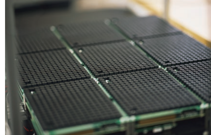
▲超音波フェーズドアレイ。直径1cmの超音波スピーカーが多数配置されている。
