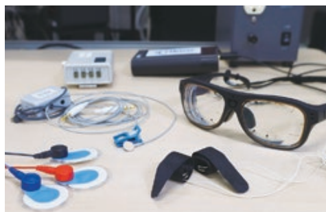
使用するセンサー 左上から時計回りに、脳波、視線の向き、発汗量、心電位を測ることができる
