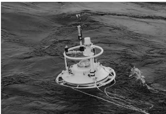
新しく開発した観測ブイで大気・海洋境界面の乱流フラックスを計測する Measurement of turbulent flux at the air-sea interface using a newly developed buoy
