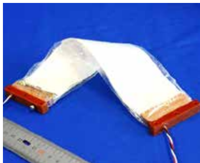
柔軟構造で高出力を実現する静電人工筋アクチュエータ Flexible and high-power Electrostatic Artificial Muscle
