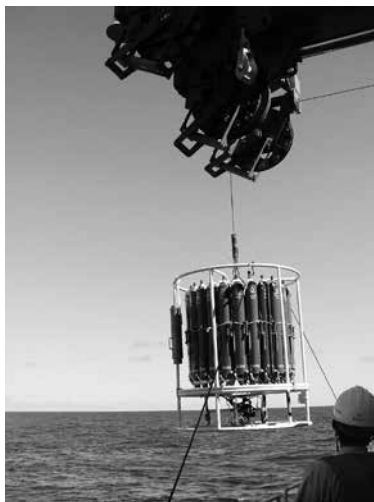
学術研究船「白鳳丸」における海水中の基本パラメーター（CTD）の鉛直分布観測と海水試料の鉛直採水 Observation of vertical profiles of basic parameters (CTD) in seawater and vertical sampling of seawater on the R/V "Hakuho-maru"
