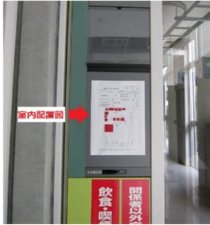
緊急時に、消防が消火活動を円滑に行えるよう、各部屋のドアの横に部屋の什器のレイアウトと危険な物の有無の情報を1枚にまとめた室内配置図を掲示しています。また、各部屋の内側にも緊急連絡表が掲示されており、休日や夜間に緊急事態が発生した場合、救急隊などが研究室の構成員と連絡が取れるようになっています。
