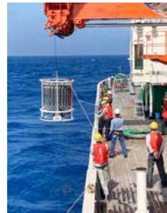
学術研究船「白鳳丸」における海水中の基本パラメーター（CTD）の鉛直分布観測と海水試料の鉛直採水 Observation of vertical profiles of basic parameters (CTD) in seawater and vertical sampling of seawater on the R/V "Hakuho-maru"
