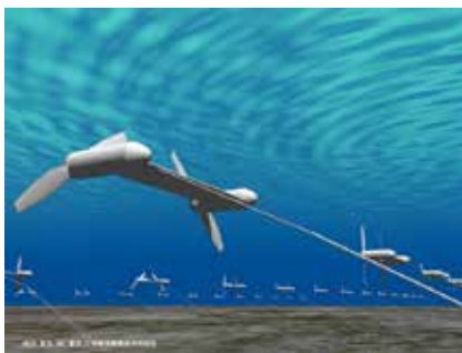
浮遊式海流発電システム Floating Type Ocean Current Turbine System
