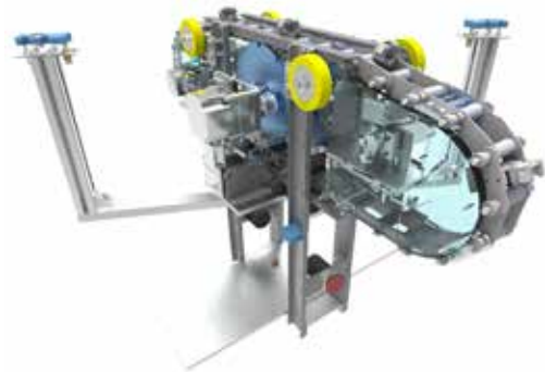
HanGrawler: 無限軌道機構を用いた天井移動ロボット HanGrawler: Large-payload and high-speed ceiling mobile robot using crawler
