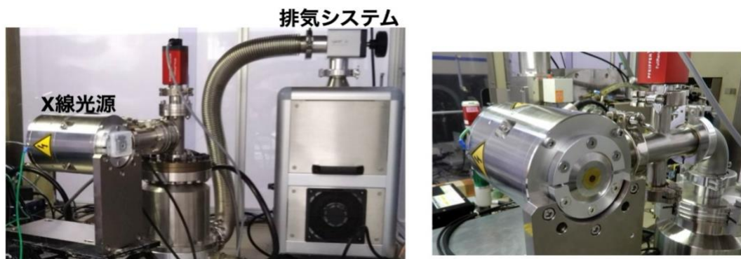
図 2：自作した小型 X 線光源写真
