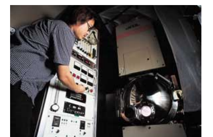
熱プラズマスプレー-CVD装置 総合研究実験棟<寺嶋研究室>
